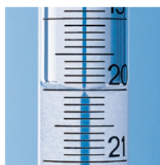
SILBERBRAND Bande photophore Traits de division. La lecture se fait au point où se touchent les deux pointes.
