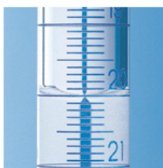
BLAUBRAND® Bande photophore Marque circulaire aux points principaux. La lecture se fait au point où se touchent les deux pointes.
