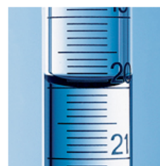
SILBERBRAND Traits de division. La lecture se fait au point le plus bas du ménisque.
